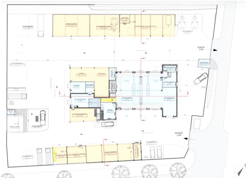
*On discerne sur le plan ci-dessus en partie bleue, le volume qui est en grande partie chauffé, les alvéoles de stockage et de travail, traversantes, se trouvant au centre du bâtiment, de façon à réaliser une marche en avant, aussi bien périphérique autour du bâtiment central pour les véhicules lourds, qu'à travers le bâtiment afin que les véhicules puissent entrer d'un côté et sortir de l'autre.*
