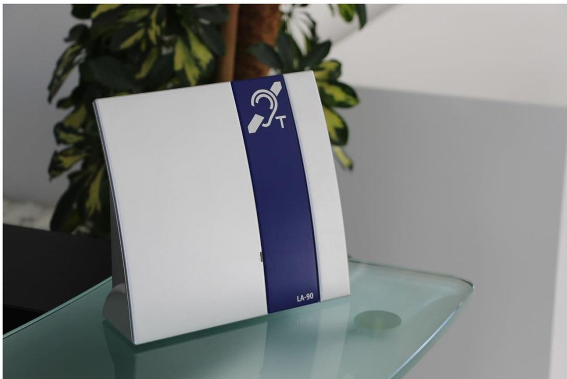
*Installation d'une boucle magnétique portable sur le comptoir d'accueil*
