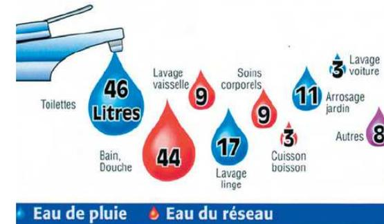
Répartition possible des usages entre eau potable et eau pluviale.
